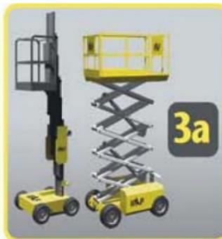
3a : Nacelles automotrices à mât vertical ou à ciseaux
